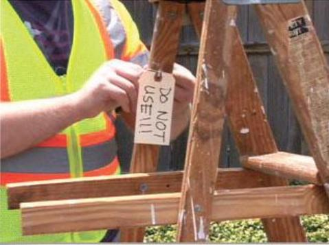
Las escaleras que están dañadas o defectuosas pueden ser muy peligrosas. Las escaleras portátiles con defectos estructurales deben ser marcadas de inmediato o etiquetadas con “NO USAR” o un lenguaje similar y deben ser puestas fuera de uso hasta su reparación.
